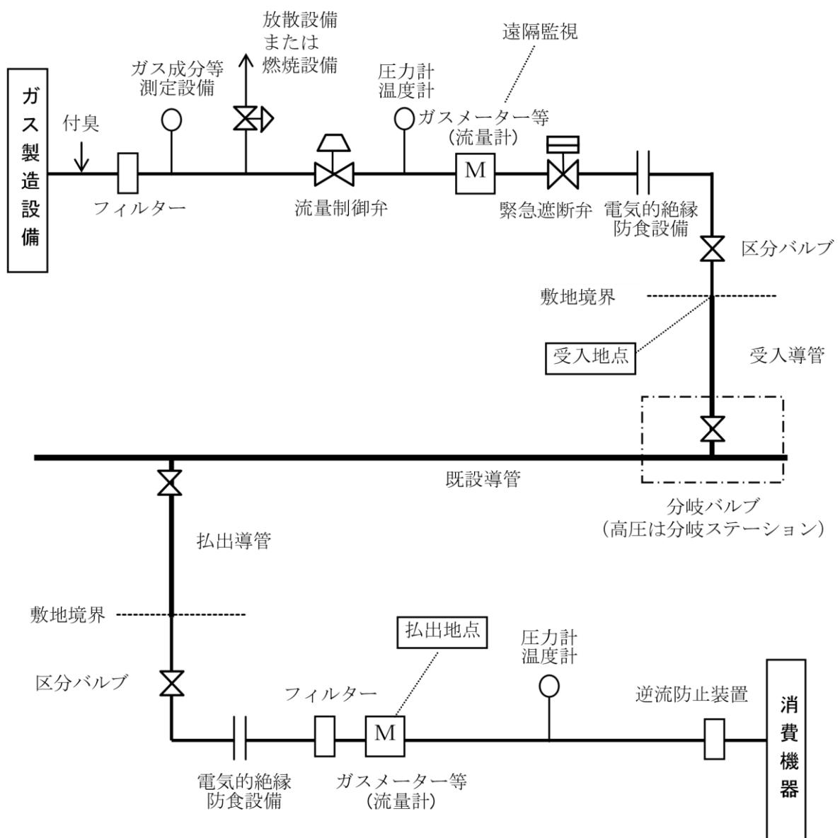
注：上図は概念図として参考に図示したものである。ガス製造形態や受入及び払出地点の位置等による差異が大きいため、詳細は個別に協議するものとする。
