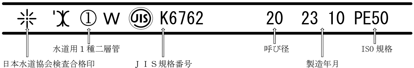
図10-2 1種二層ポリエチレン管の標示例
