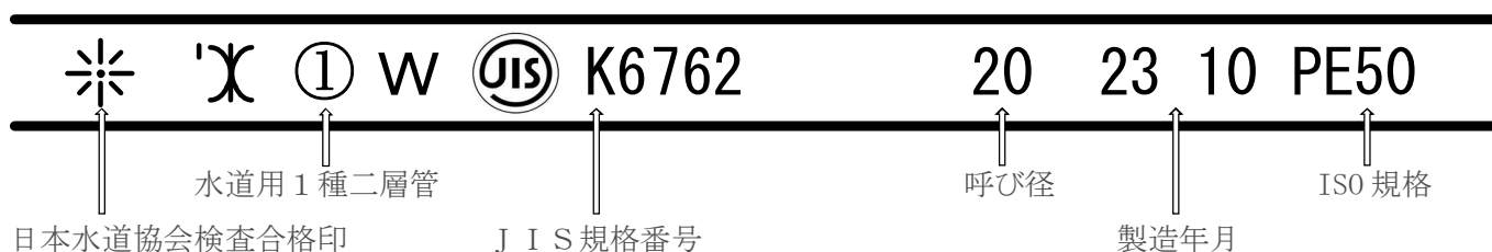
図10-2 1種二層ポリエチレン管の標示例
