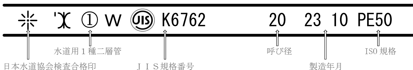
図10-2 1種二層ポリエチレン管の標示例
