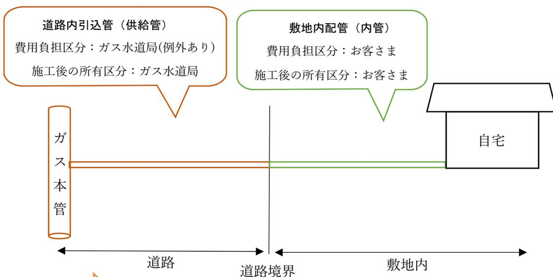
**ガス本管** 費用負担：お客さま・ガス水道局 施工後の所有区分：ガス水道局
