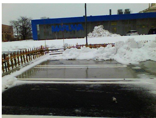
写真 5-11 東面融雪状況②（敷設ピッチ 200 mm 融雪パターン①）
