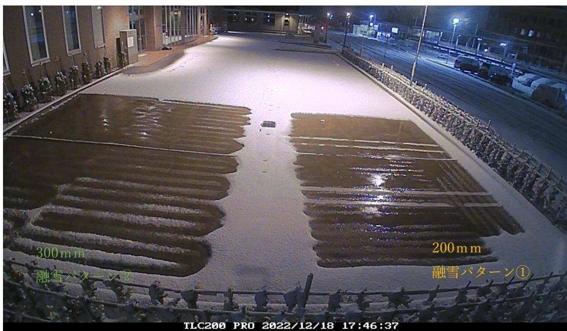
写真 5-1 東面堆雪場融雪状況 12 月 18 日 上：15 時 下：17 時
