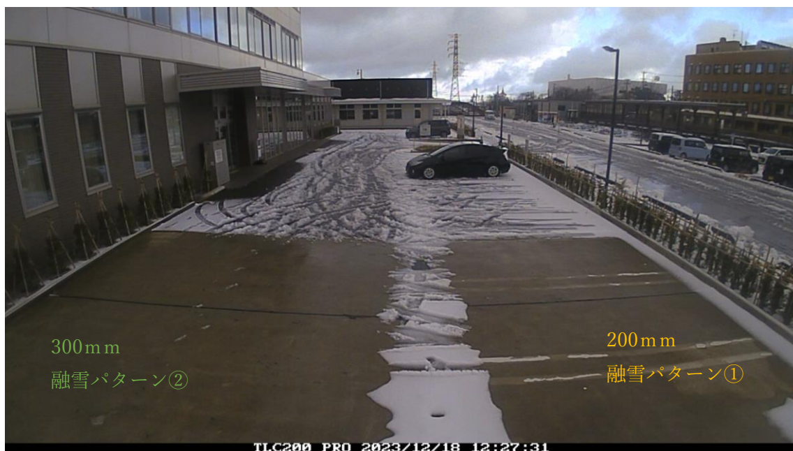
写真 5-1 東面堆雪場融雪状況 12 月 18 日 上：8 時 下：12 時
