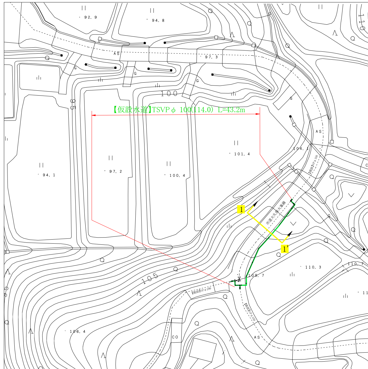
【仮設】配管平面図 S=1:500
